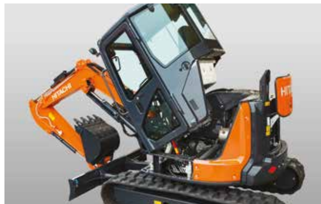
Uchylna podłoga umożliwia łatwy dostęp do silnika i zaworu kontrolnego w celu łatwego serwisowania.
