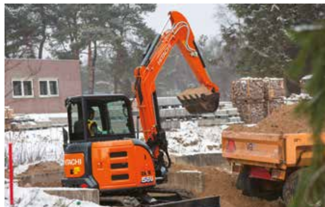
Obrotnica o skróconym tyle sprawia, że koparka ZX55U-6 sprawdza się doskonale w miejscach, gdzie przestrzeń robocza jest ograniczona.
