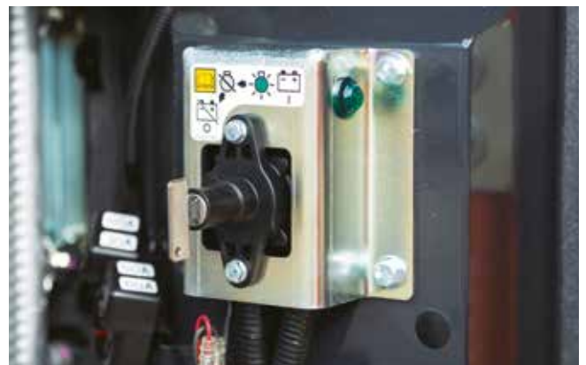
Wyłącznik akumulatora umożliwia bezpieczne wykonywanie konserwacji.
