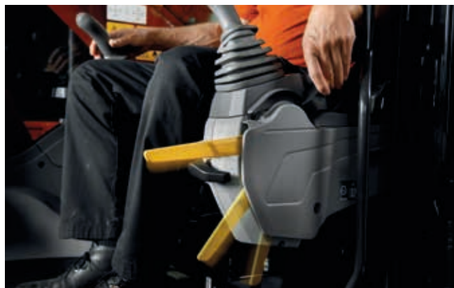
Dźwignia blokady osprzętu zapewnia większe bezpieczeństwo w kabinie.
