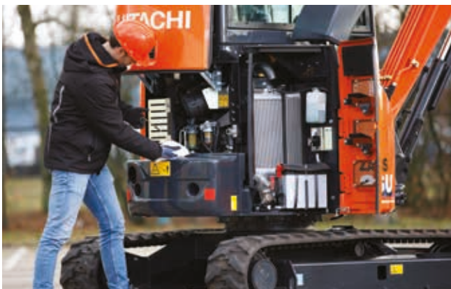
Łatwe do otwarcia pokrywy umożliwiają szybki dostęp.
