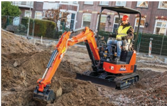
Rozszerzone podwozie gąsienicowe zwiększa wszechstronność i stabilność.
