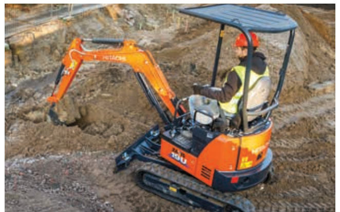
Zadaszenie na trzech słupkach zwiększa widoczność.
