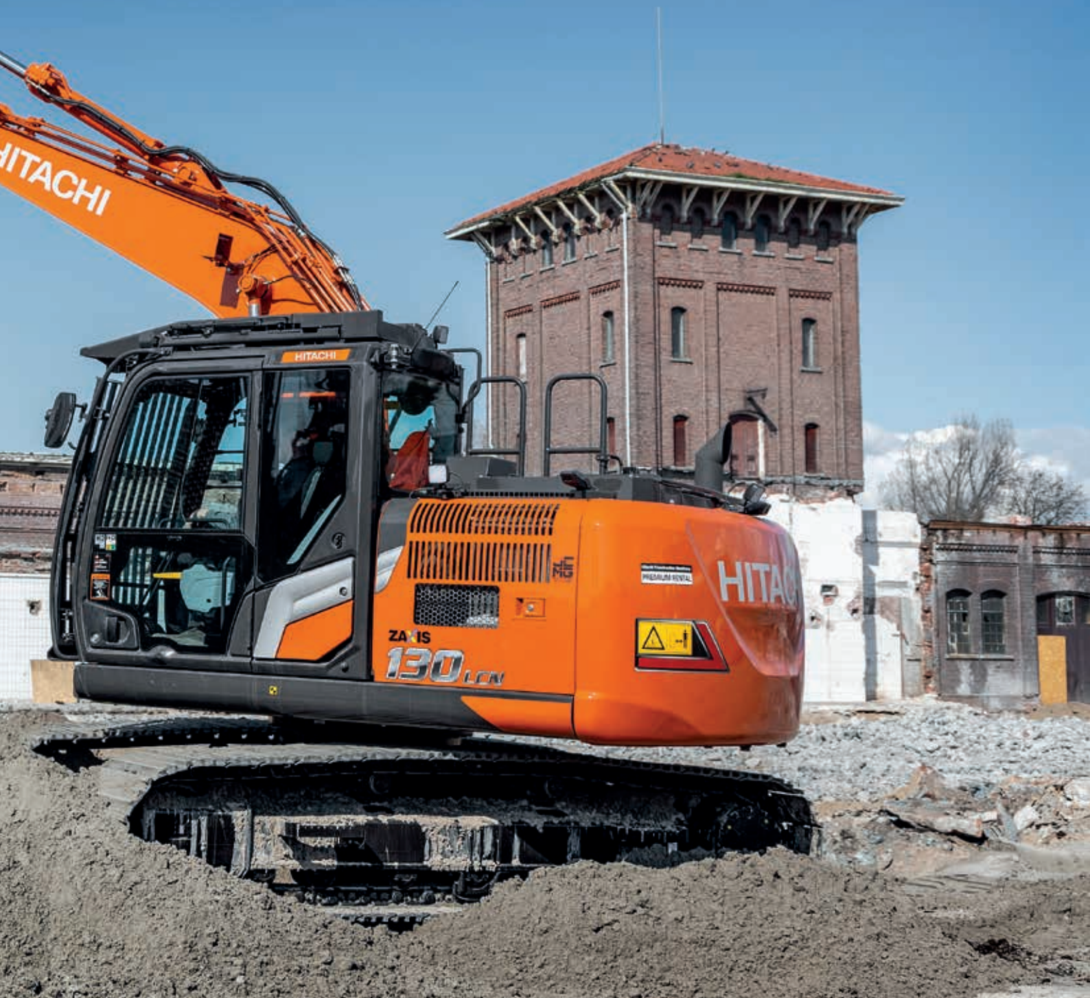
Układ hydrauliczny HIOS V zwiększa prędkość pracy osprzętu przedniego i redukuje zużycie paliwa.
