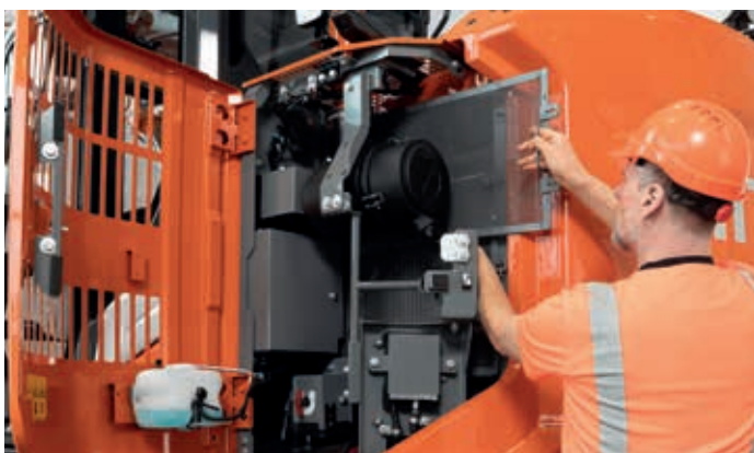
Powiększone drzwi chłodnicy (ZX135US-7) zapewnia łatwy dostęp w celu czyszczenia i konserwacji.
