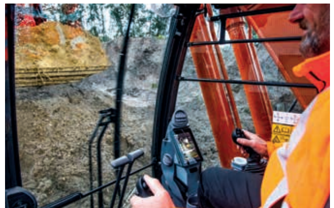
Szersza wycieraczka zapewnia lepszą widoczność.
