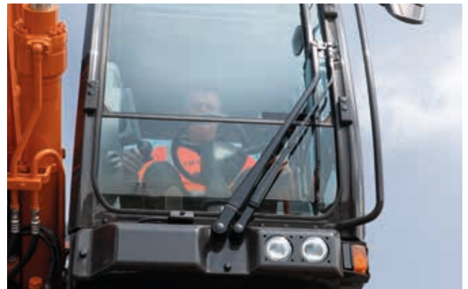
Die größere Wischfläche der parallelen Scheibenwischer verbessert die Sicht bei schwierigen Arbeitsbedingungen.
