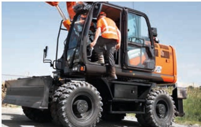
Die tiefer angebrachte, erste Trittstufe macht das Einsteigen in die Kabine sicherer und einfacher.
