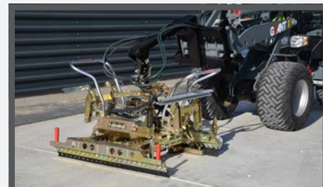
NL MACHINALE LEGKLEMMEN EN STONE INSTALLATION CLAMP DU PFLASTERVERLEGEZANGE FR GRIFES DE DÉPÔT MACHINALES
