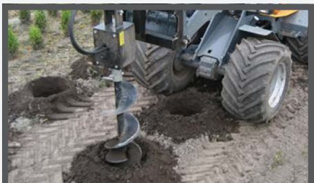
NL GRONDBOREN HYDR. EN HYDRAULIC EARTH DRILLS DU ERDBOHRGERAT FR TARIÈRES HYDRAULIQUES
