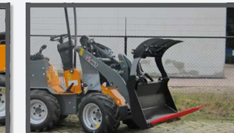
NL MESTVORKEN MET KLEM COMPACT EN MANURE FORKS WITH CLAMP COMPACT DU DUNG- UND SILLAGEZANGE KOMPAKT FR FOURCHES À FUMIER, AVEC GRIFFE COMPACT
